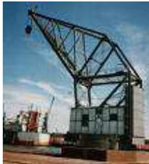
Der noch erhaltene Drehscheibenkran von 30 t Tragkraft, der zum Löschen und Laden einzelner schwerer Frachtstücke sowie zum Bewegen größerer Ausrüstungsgegenstände für die Schiffe erforderlich war, wurde ebenfalls mit Druckwasser vom Kraftwerk betrieben. In dem Gebäude nördlich der kleinen Kaiserschleuse galt die Beleuchtung als besonders fortschrittlich. Der Strom für die Bogenlampen wurde von zwei Wechselstromgeneratoren, die von zwei Dampfmaschinen angetrieben wurden, erzeugt.
